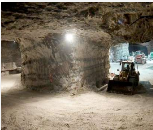
Ilustración 2.- Sistema de explotación subterráneo "cámaras y pilares".
