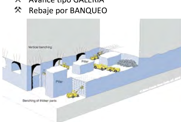
Ilustración 2.- Sistema de explotación subterráneo "cámaras y pilares".
