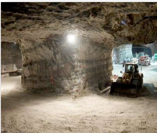
Ilustración 2.- Sistema de explotación subterráneo "cámaras y pilares".
